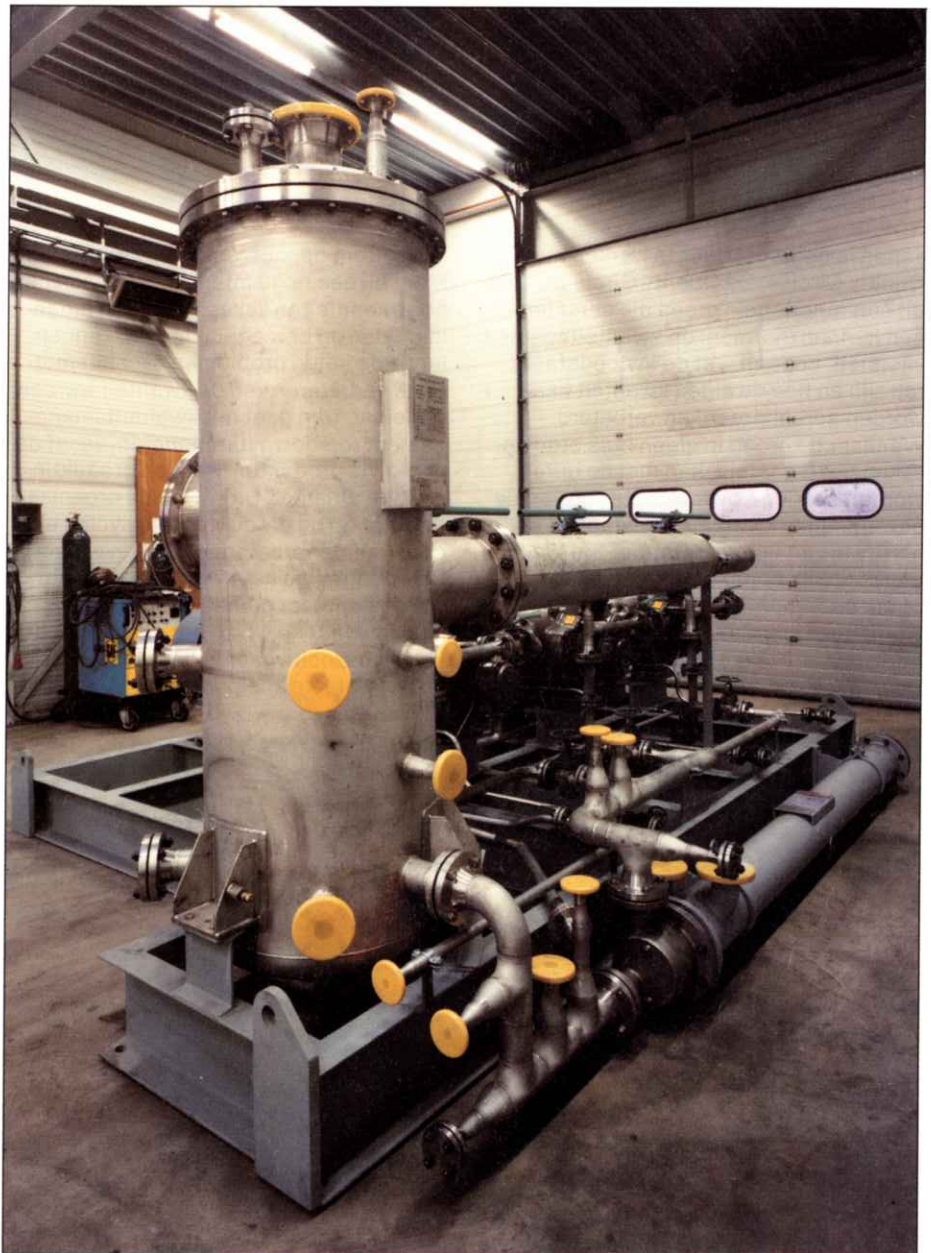
Vacuümunit t.b.v. een olieraffinaderij geheel uitgevoerd in roestvaststaal 316L.
